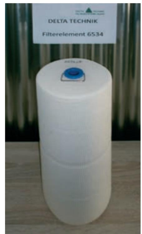
Dieses Filterelement zeichnet sich durch hohe Wasseraufnahme-Kapazität aus: bis zu 5 Liter je Element bei einer gleichzeitig extrem hohen Filterfeinheit bis zu 1 Mikrometer. Das Filterelement 6534 wurde eigens für stark belastete Hydrauliksysteme und Hydrauliköle der Viskositätsgruppen 20 - 55 entwickelt.
